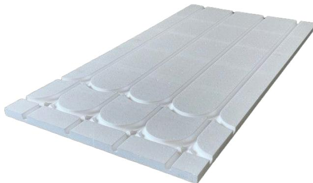
Das **Mäanderelement Ardus EPS 300** wird im Trockenbau verwendet und dient als Träger für Heizrohre. Das Element besteht aus EPS 300 kPa. Die Heizungsrohre lassen sich in Mäanderform verlegen. Das Element ist in Plattenstärken von 20, 25 bis 30 mm verfügbar, jeweils mit einem Verlegeabstand von 150 oder 200 mm. Das System zeichnet sich durch sein leichtes Gewicht und seine flache Aufbauhöhe aus.
